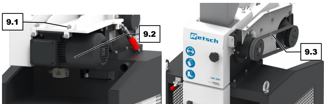
Fig. 28: Allentamento del motore
