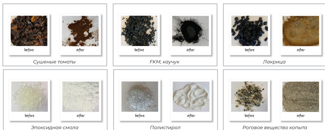
Рис. 6: Различные образцы до и после измельчения в мельнице MM 500 control
