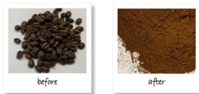
Рис. 3: Слева: Обжаренные зерна кофе до и после измельчения в мельнице MM 500 control (на размольный стакан объемом 125 мл из нержавеющей стали: 5,4 г кофе, размольные шары из нержавеющей стали 8x20 мм), заданная температура -100 °С, предварительное охлаждение в течение 25 мин, измельчение за 10 циклов (1 мин, 30 Гц + 0,5 мин, 5 Гц).
