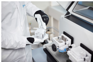
Рис. 2: Размольные стаканы после криогенного размола в мельнице MM 500 control
