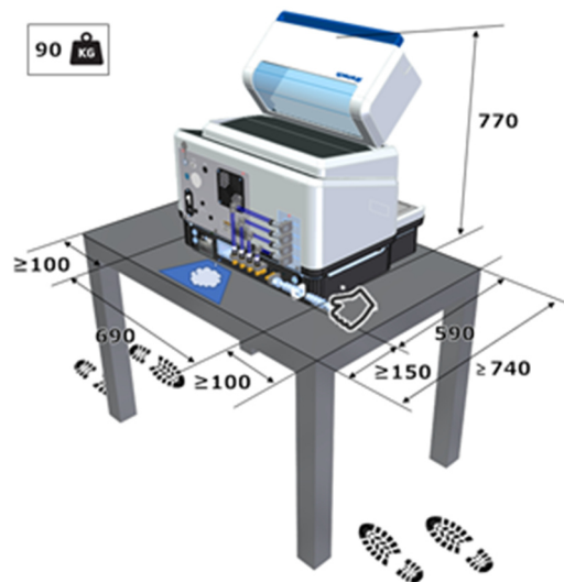
Fig. 25: Requisitos al lugar de colocación
