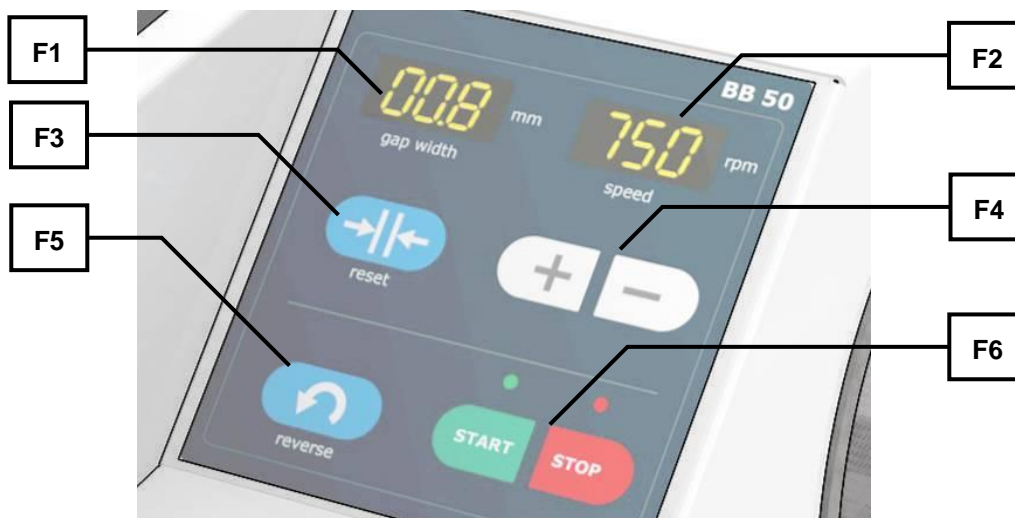
Fig. 11: Vista del panel de mando y de las pantallas
