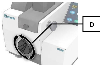
Fig. 20: Abertura de salida
