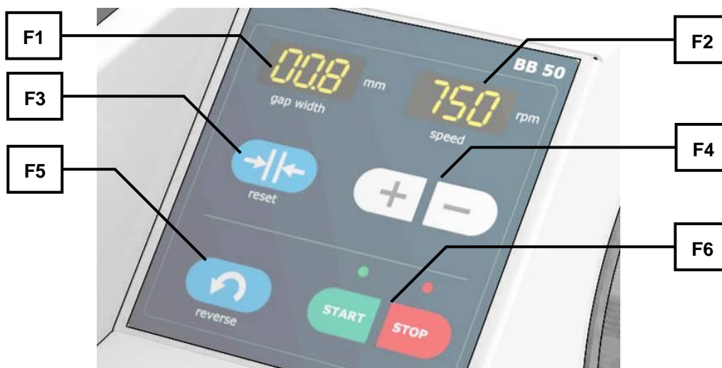
Рис. 11: Вид панели управления и элементов индикации
