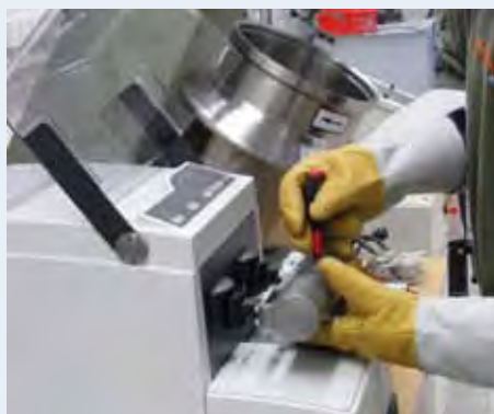
В Котбусе CryoMill используется для измельчения хрена, чтобы сохранить его типичную остроту.
