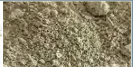
MM400精细研磨 50毫升不锈钢研磨罐，1*25毫米不锈钢研磨球， 30Hz，2min
