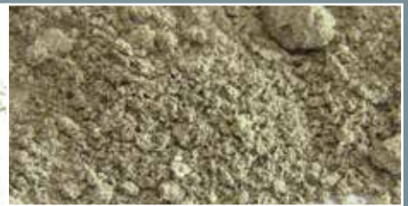
MM400で粉砕された微粉末 粉砕ジャー=ステンレス製50mL、粉砕ボール=ステンレス製 \phi 25mm 振とう数=30Hz、粉砕時間=2分
