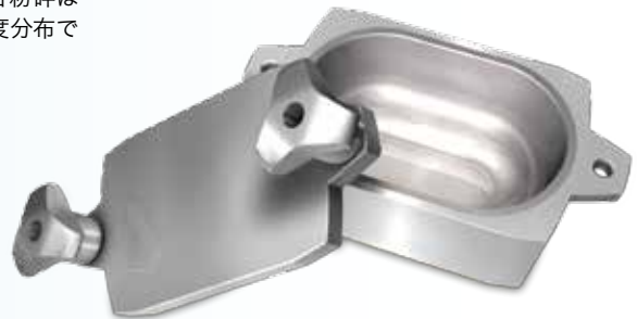
図3: 試料の混合を最適化する新デザインの粉砕ジャー
