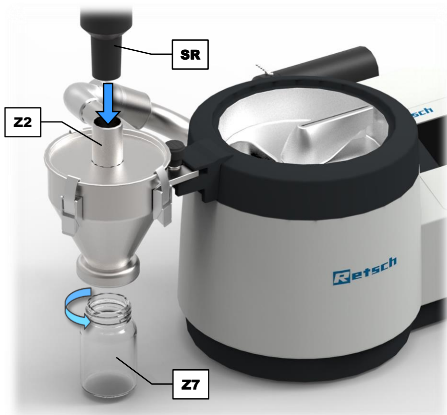
III. 30 : Raccord de l'aspirateur industriel au séparateur cyclonique monté
