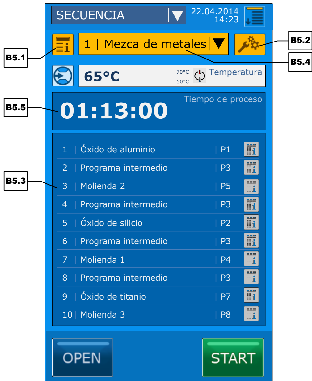
Fig. 33: Funcionamiento en el modo de secuencia
