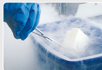
Охрупчивание образца в размольном стакане из нержавеющей стали в жидком азоте
