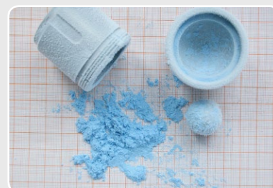
Результат измельчения в MM 400 - гомогенный порошок
