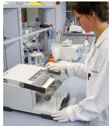
Гизела Боле измельчает образцы шерсти на вибрационной мельнице MM 400
