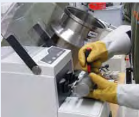
В Котбусе CryoMill используется для измельчения хрена, чтобы сохранить его типичную остроту.
