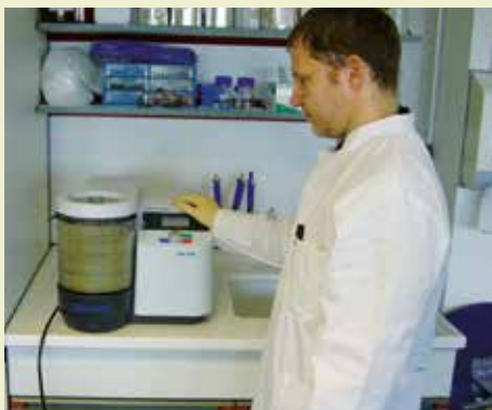
В Региональном Подразделении Уголовного Розыска в Дрездене ножевая мельница GRINDOMIX GM 300 используется для измельчения ростков конопли.
