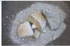
Рис. 3: Недосев (160 гр). Стандартный просеиватель с эксцентриковым двигателем
