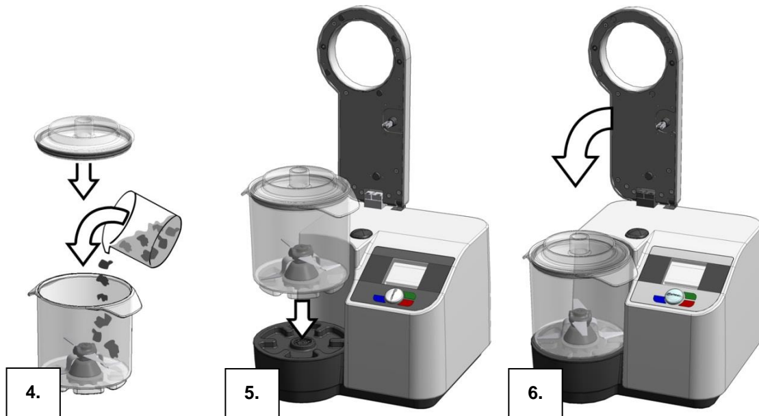
Abb. 12: Mahlbecher einsetzen und Gerät schließen
