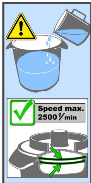
図 14 : 粘性の低い液体試料を粉砕するときの最大回転数
