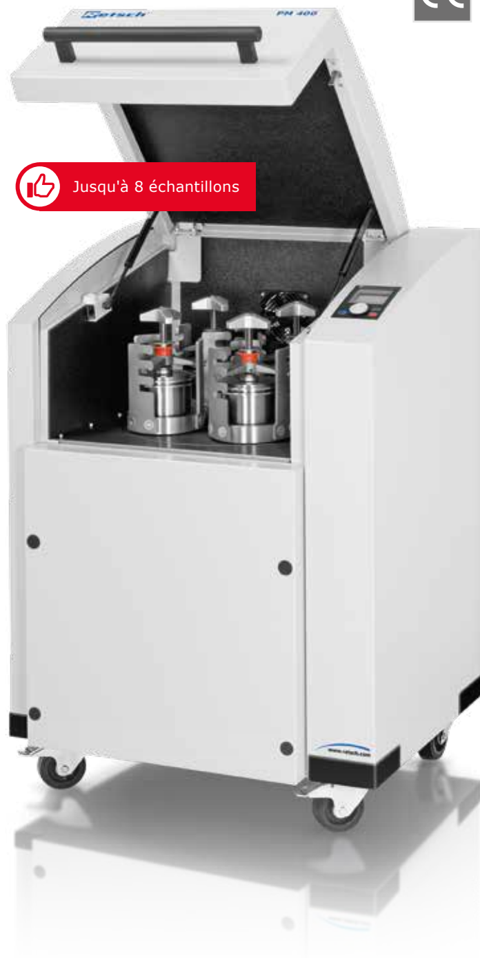
Broyeur planétaire à billes PM 400 / PM 400 MA
