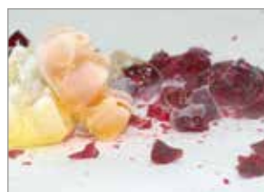
Matériau fragilisé à l'Azote liquide
