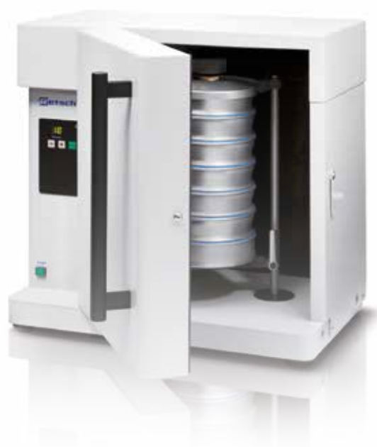
Tamiseuse à chocs AS 200 tap avec enceinte d'insonorisation et pile de tamis
