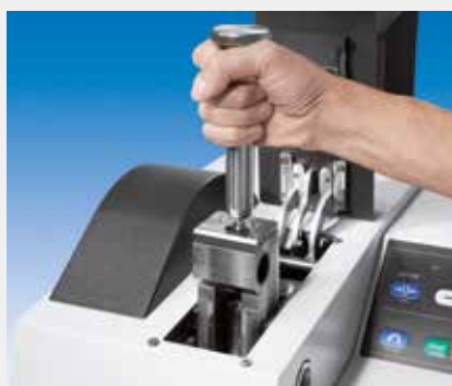
Braccio di frantumazione removibile manualmente
