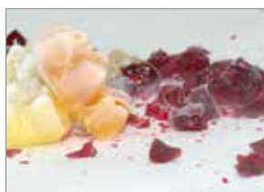
Infragilimento del campione con azoto liquido
