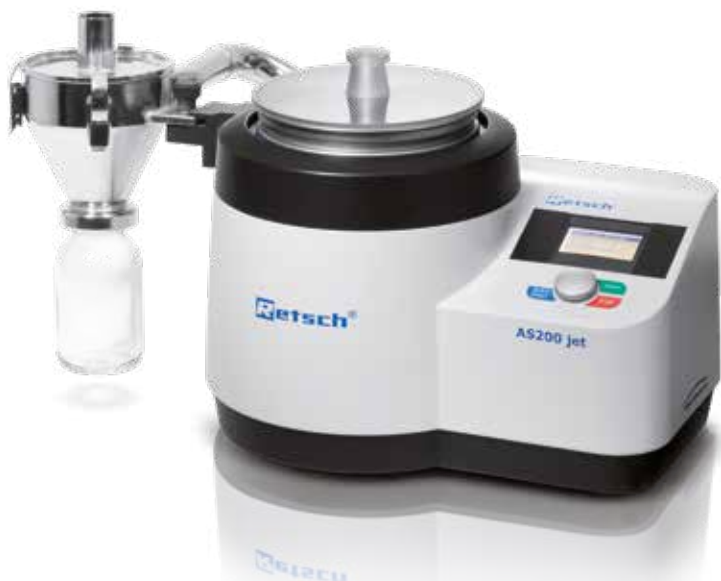
Setacciatore a getto d'aria AS 200 jet con ciclone e bottiglia di campionamento
