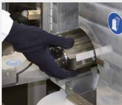
I rotori ad innesto facilitano la pulizia
