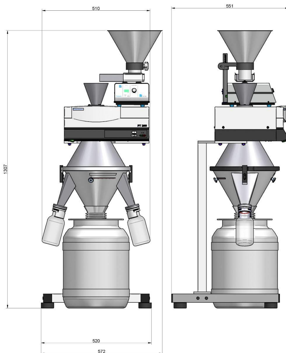
Рис. 2: Размеры Размеры без вибропитателя Высота: 1060 мм Ширина: 520 мм
