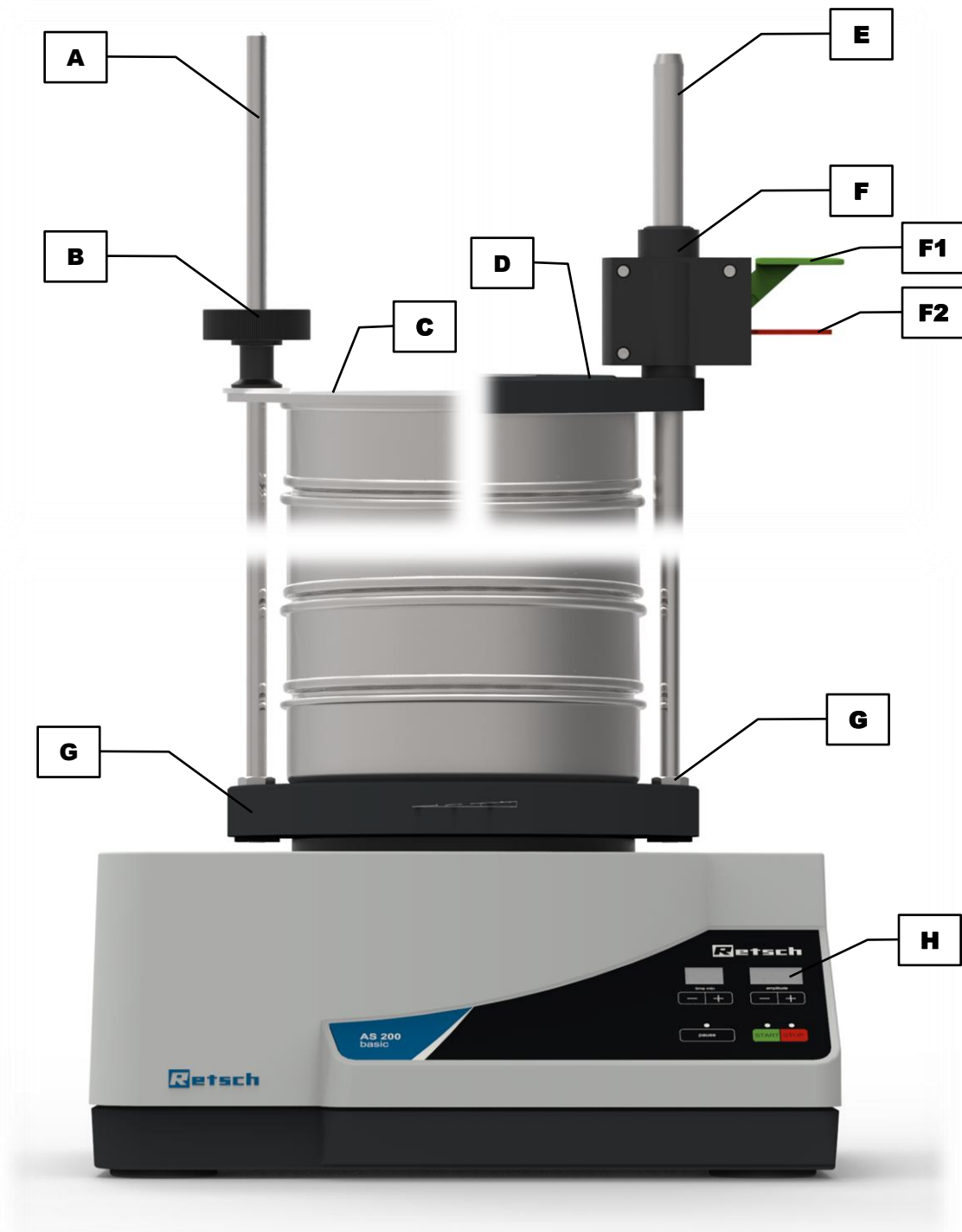
III.8: Vue frontale de l'appareil avec différentes unités de serrage de tamis
