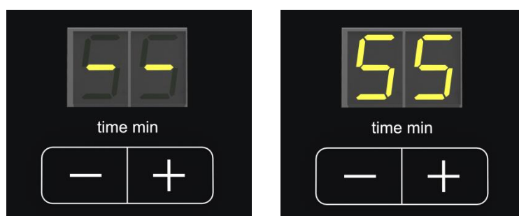
Fig. 14: Configuración del tiempo en funcionamiento continuo (izquierda) o con un tiempo de proceso (derecha)
