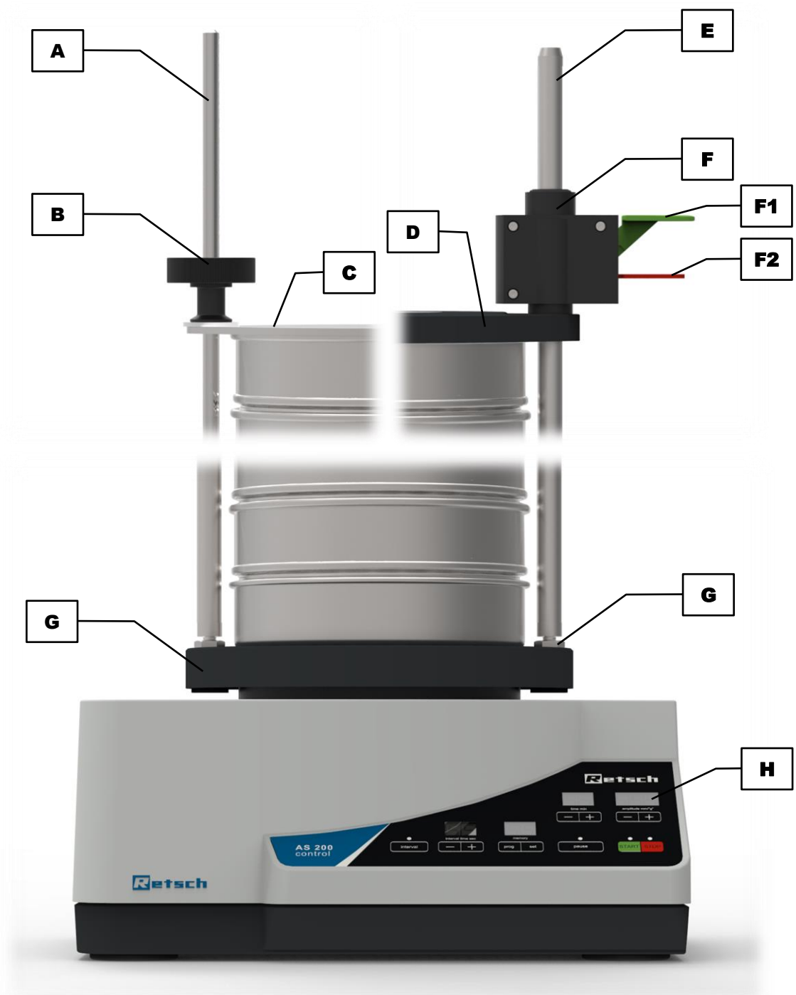
Fig. 8: Vista frontal del aparato con diferentes dispositivos de fijación de tamices
