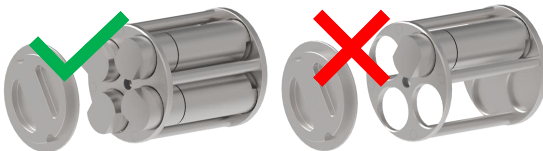
Рис. 43: допустимое расположение стальных размольных стаканов в адаптере
