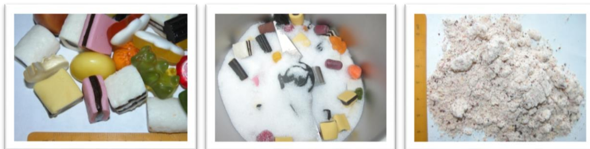
Fruchtgummi vor und nach der Zerkleinerung mit Trockeneis in der GRINDOMIX GM 300
