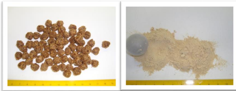
Müslipellets vor und nach der kryogenen Zerkleinerung in der ZM 200
