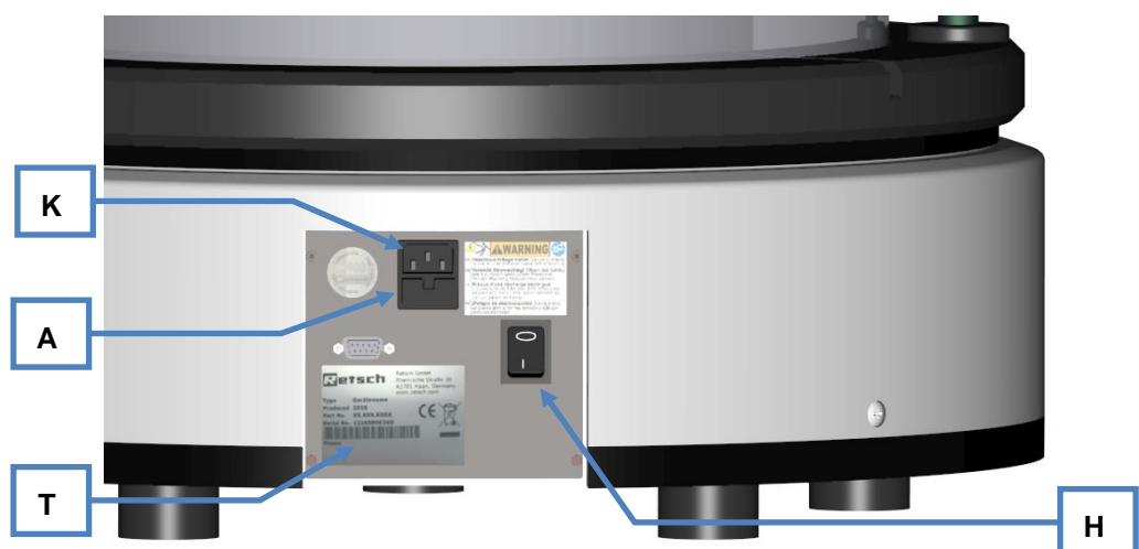
Fig. 20: Sostituzione dei fusibili
