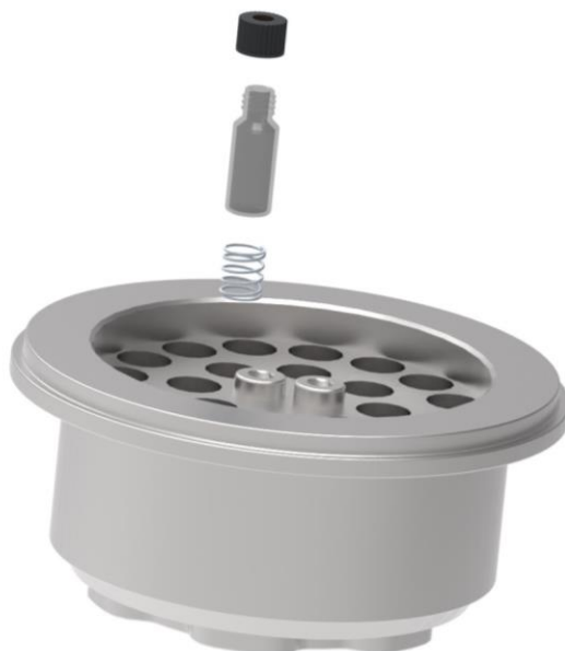
Fig. 65: Disegno esploso di adattatore con molla di compressione e contenitore da 1,5 ml
