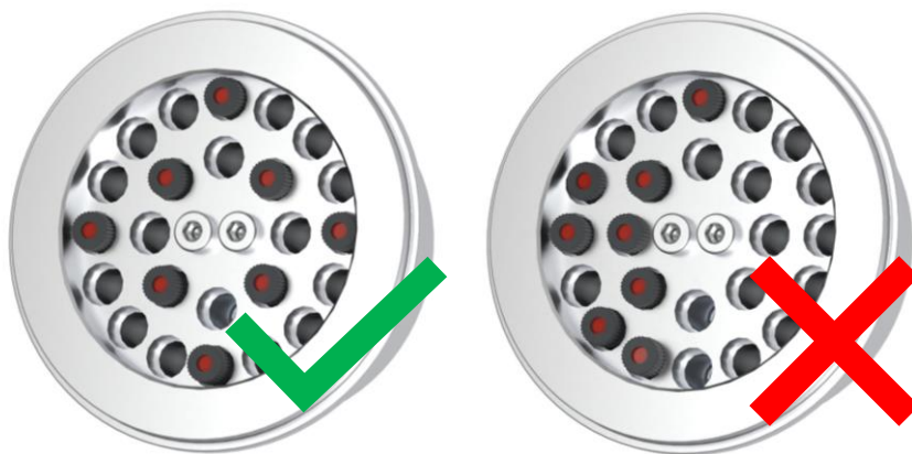
Fig. 66: Disposizione consentita dei contenitori di centro nell'adattatore
