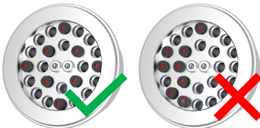
図 65: アダプター内のガラス容器の許容配置
