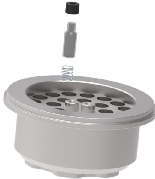
Fig. 65: Esquema del despiece del adaptador con resorte de compresión y recipiente de 1,5 ml
