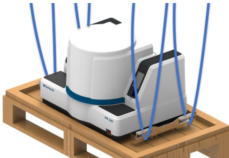
Fig. 17: Transporte con dispositivo y cintas de elevación
