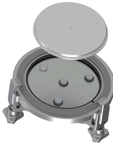
图 24：行星式球磨仪传感器单元下侧
