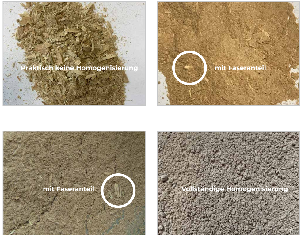
Abb. 9: Mahlergebnisse von getrockneten Pflanzenproben in den verschiedenen Bechergeometrien in der PM 200 und PM 300.
