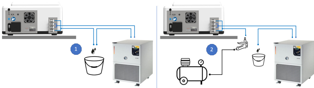
Abb. 10: Entleeren der Rohrleitungen mit einem Druckluftaggregat
