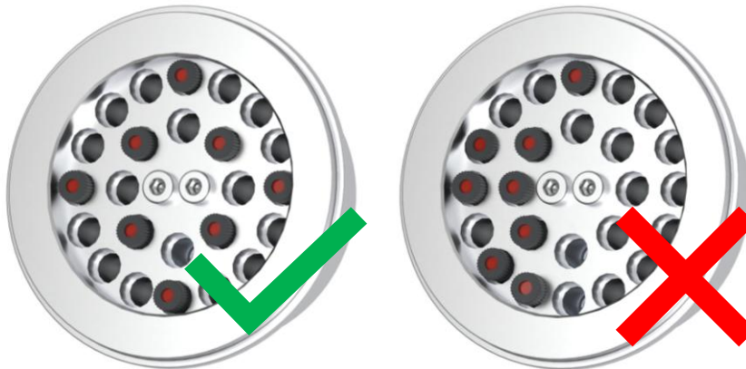
Abb. 35: Zulässige Anordnung der Glas Gefäße im Adapter
