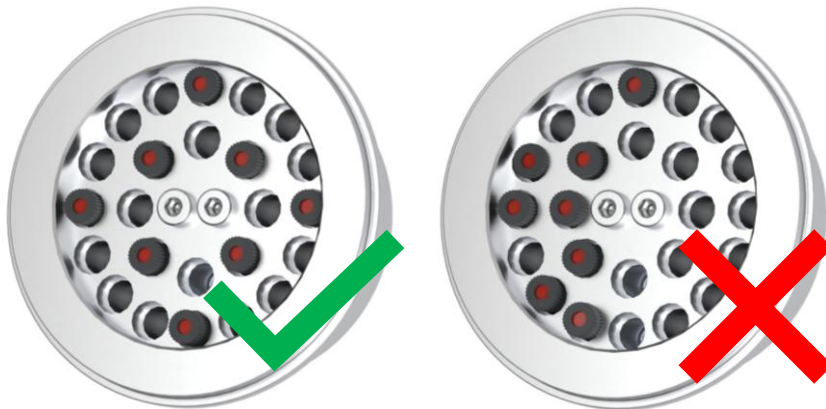
图35：适配器中玻璃容器允许的布置方式
