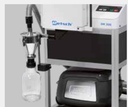
Zyklon-Sauger-Kombination für gute Kühlung des Mahlgutes und der Schneidwerkzeuge (SM 200 & SM 300)
