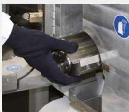
Push-Fit Rotoren für schnelle und einfache Reinigung (SM 100, SM 200 & SM 300)
