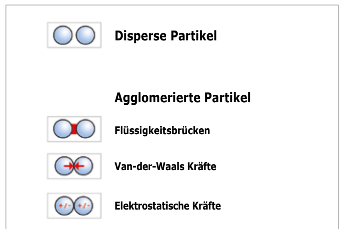
Abb. 9: Haftkräfte zwischen Partikeln, die das Siebergebnis beeinträchtigen können
