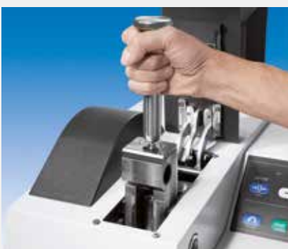
Einfache Entnahme des vorderen Brecharms ohne Werkzeug
