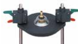
Dispositivo universal para tamizado en húmedo "comfort"
