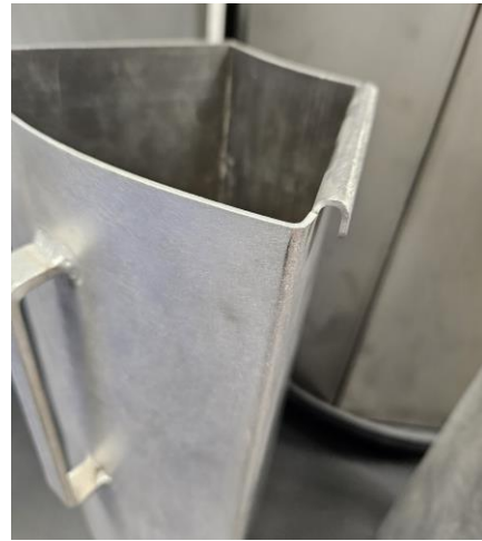
Abb. 16: Verbindung von Teilsegmenten mittels ineinander haken
