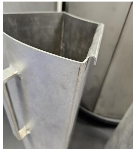
Рис. 16: Соединение сегментов деления путем взаимного зацепления
