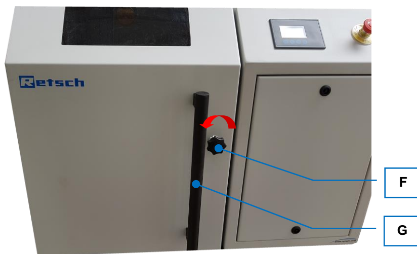
Рис. 10: Открыть дверь корпуса
