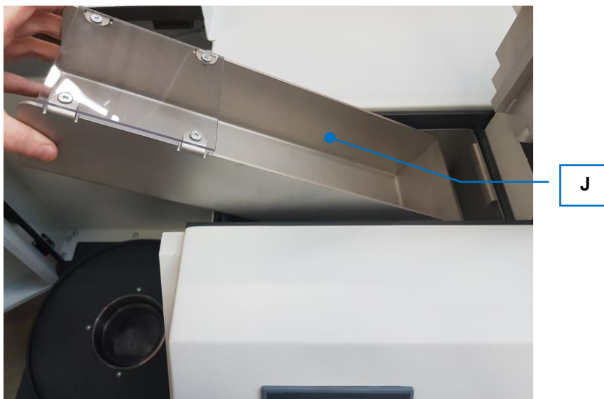
Рис. 18: Установка вибрационного лотка
