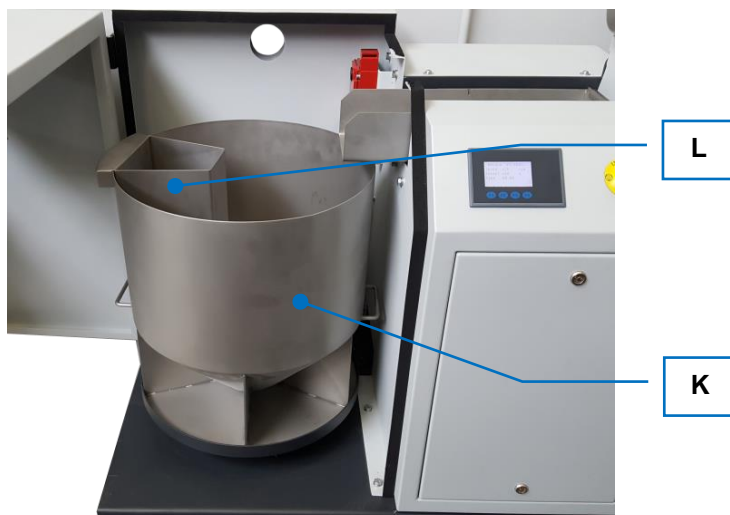
Рис. 13: Непрерывный модуль деления с одним сегментом
