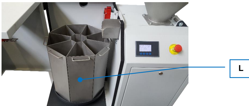
Рис. 14: Сменный модуль деления с восемью сегментами
