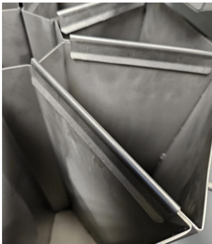
Рис. 15: Скрепление сегментов деления с помощью соединительных пластин
