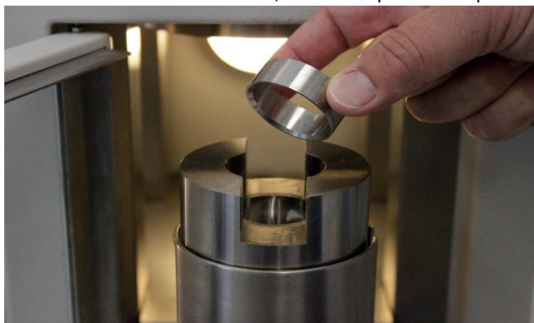
Рис. 24: Установка стального кольца
