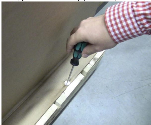
Рис. 3: Удаление внутреннего картонного ящика
