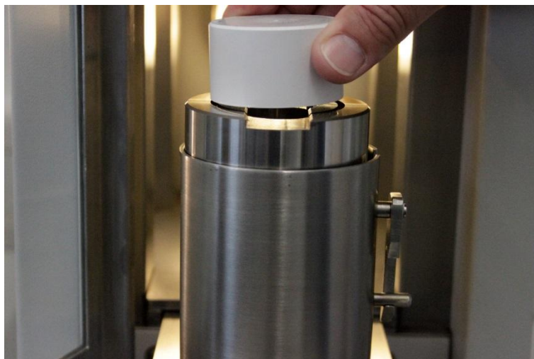
Рис. 18: Установка вспомогательного выпрессовочного приспособления
