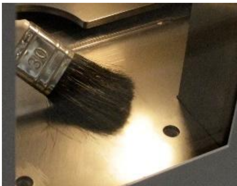
Рис. 42: Очистка камеры прессования
