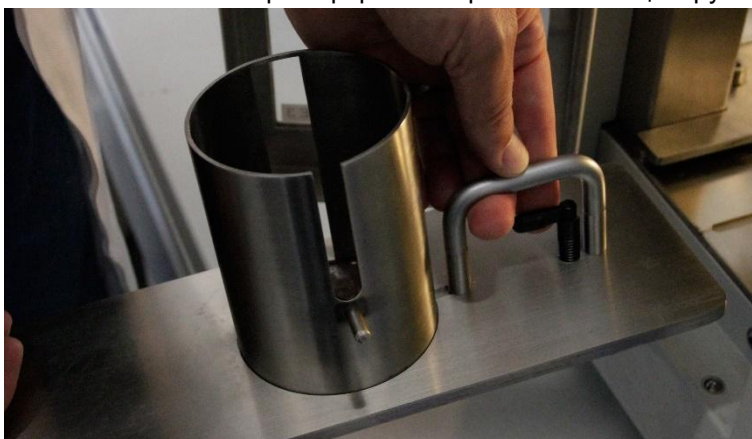
Рис. 39: Вытаскивание салазок прессформы
