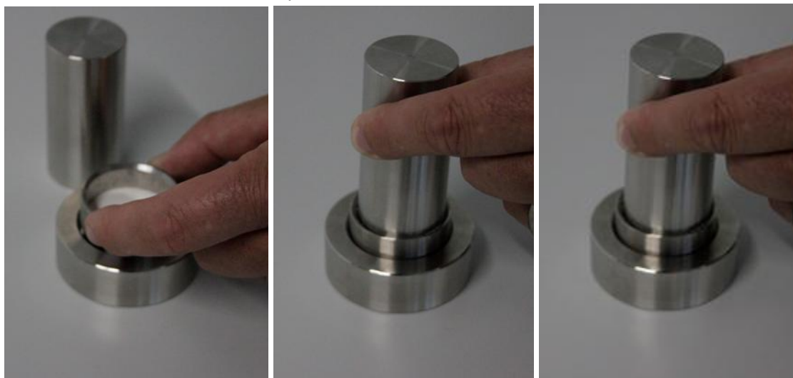
Рис. 26: Удаление пробы из стального кольца
