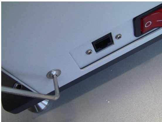
Рис. 5: Снятие заднего щитка
