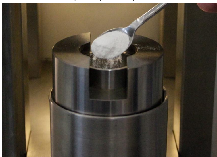
Рис. 25: Наполнение материалом пробы
