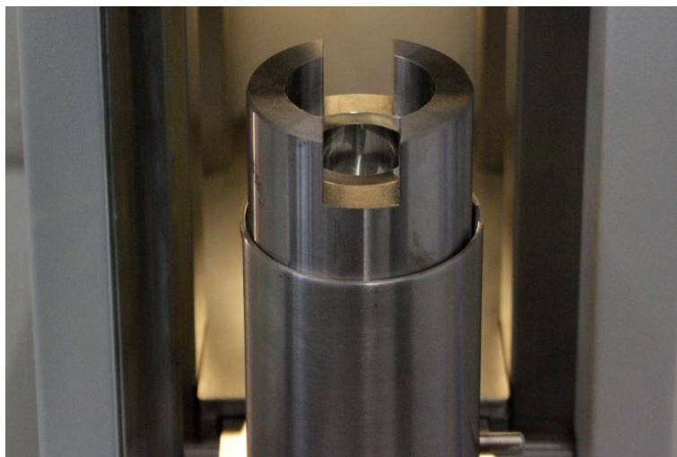
Рис. 23: Прессформа для стальных колец
