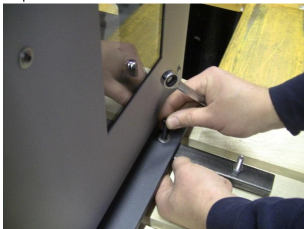
Рис. 4: Откручивание винтов на транспортировочном приспособлении
