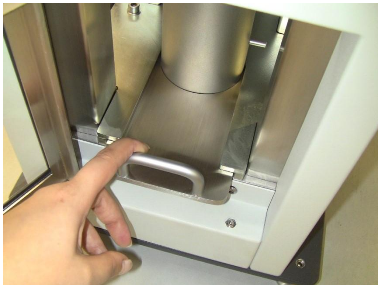
Рис. 8: Вытягивание салазок прессформы
