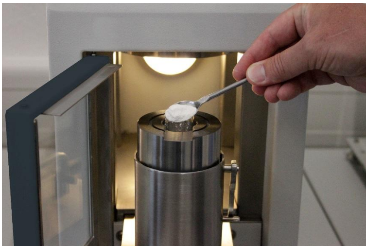
Рис. 11: Наполнение материалом пробы
