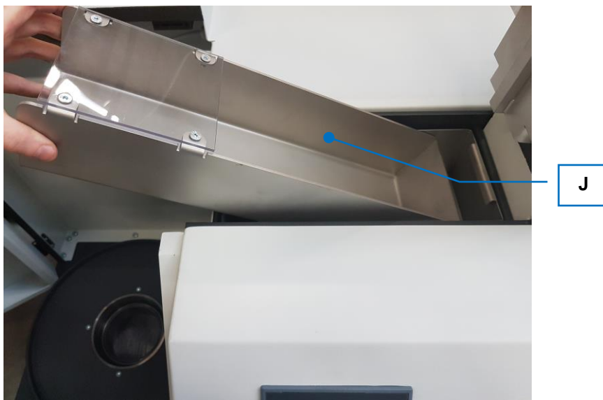
図18：試料供給機シュートの取り付け
