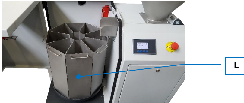
図14：バッチ分割モジュール（8分割）
