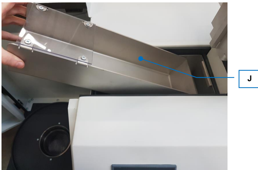
III. 18 : Mise en place de la goulotte vibrante
