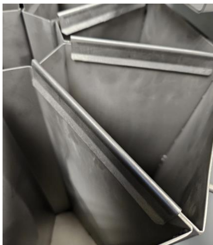
III. 15: Liaison de segments partiels au moyen de tôles de liaison
