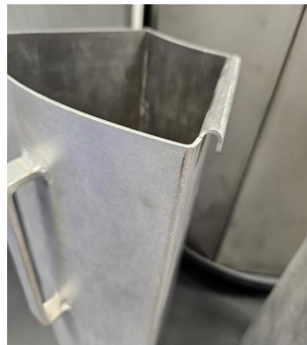
III. 16: Assemblage de segments partiels par crochets
