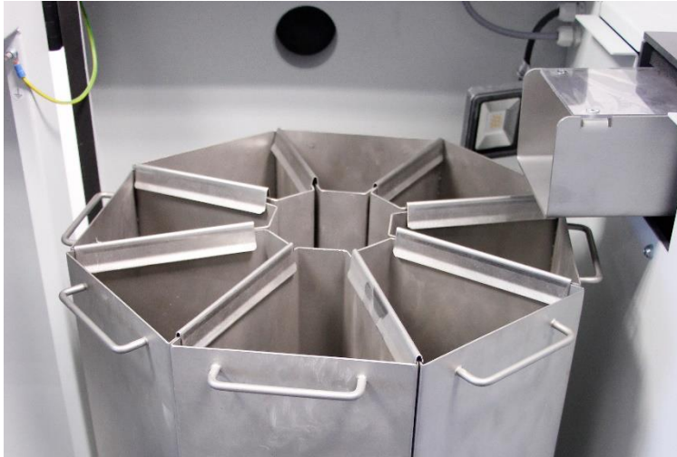
III. 3 : Appareil avec goulotte vibrante standard insérée
