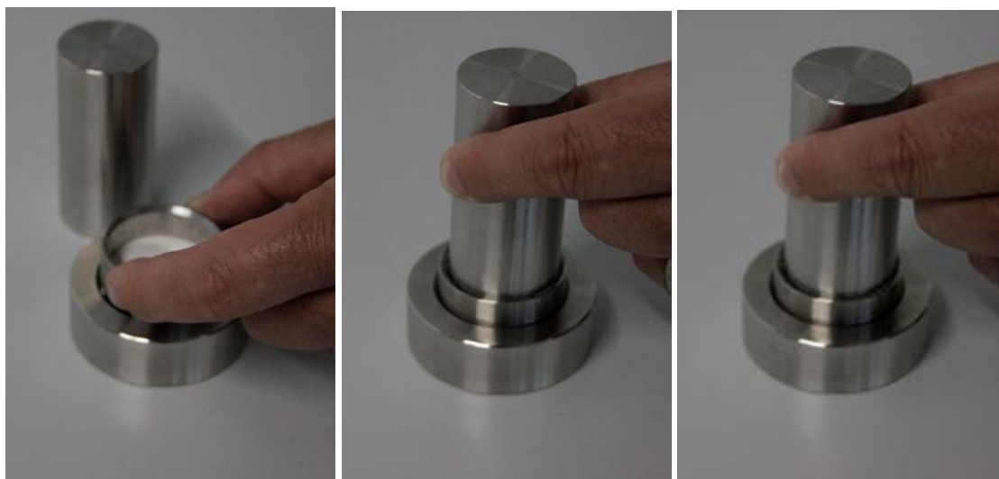
図26： 成型されたペレットをスチールリングから取り出す
