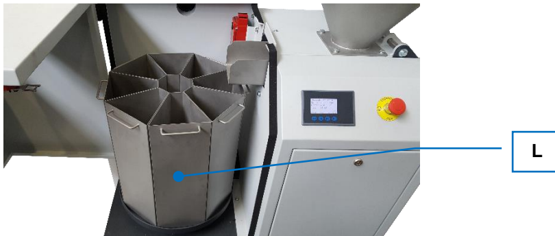
Fig. 14: Módulo divisor discontinuo con ocho segmentos
