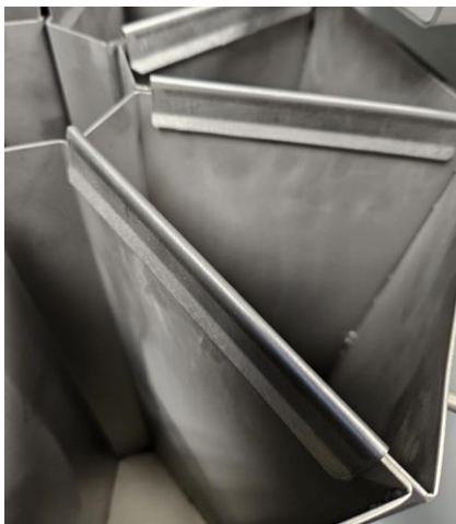
Fig. 15: Unión de segmentos divisores mediante placas de unión
