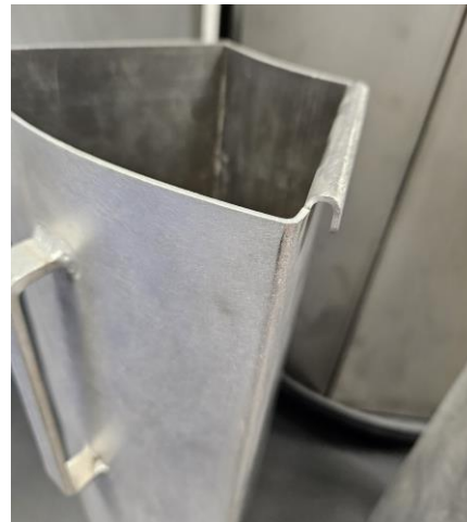
Fig. 16: Unión de segmentos divisores mediante enclavamiento por ganchos
