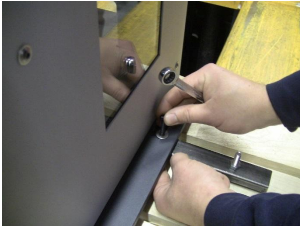
Fig. 4: Svitare le viti sul fermo di trasporto
