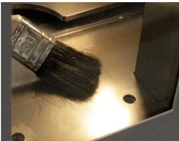
Fig. 42: Pulizia del vano di pressatura
