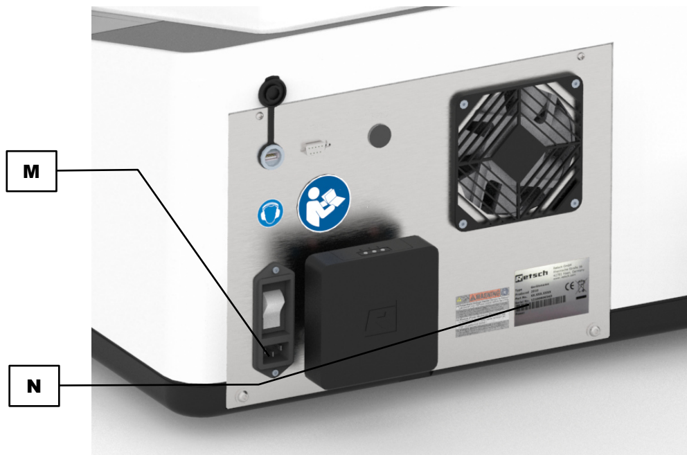
图 37：建立供电连接
