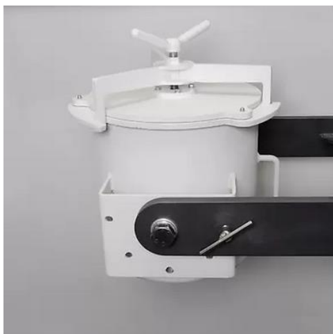
図19：蓋を閉めた状態の粉砕ドラム
