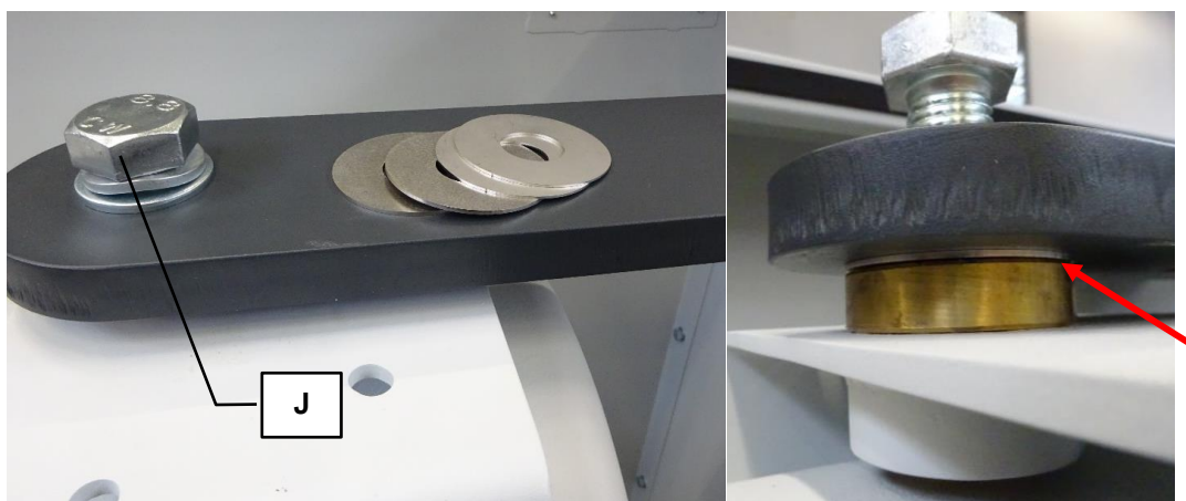
図11: 粉碎ドラムと粉碎ドラム保持具の隙間を埋める
