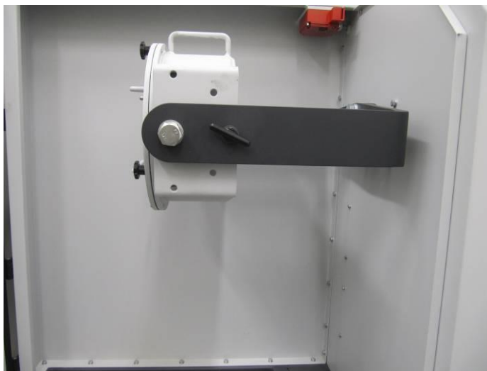
図12 : 5リットルのボールモジュール
