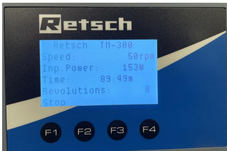
図42：粉碎プロセス中の表示, Stop on: Time
