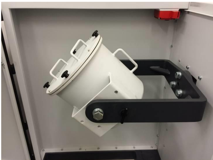
図22：混合位置に置かれた粉砕ドラム
