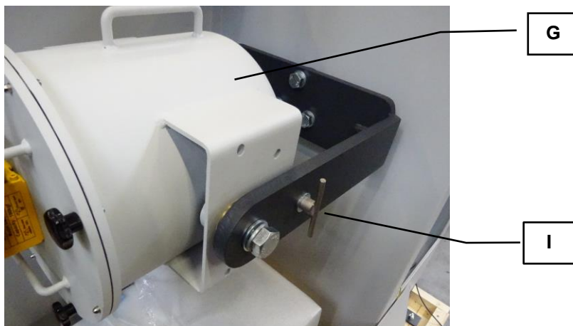
図10: 粉碎ドラムを締め付けボルトで固定
