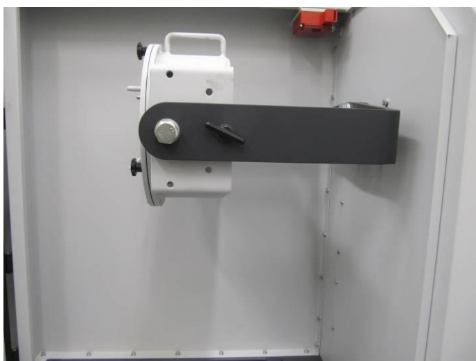
図13 : 10リットルのボールモジュール
