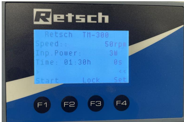
図28 : スタートメニュー — ハウジングのドアがロックされていない状態
