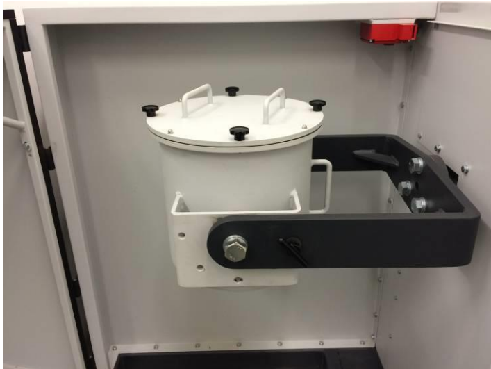
図16：投入位置に置かれた粉碎ドラム（21.7リットル）
