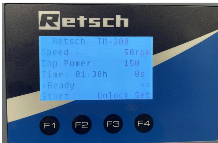
図29 : スタートメニュー — ハウジングのドアがロックされている状態
