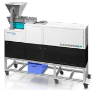
PARTIKELGRÖSSEN- & PARTIKELFORM-ANALYSATOR CAMSIZER ONLINE XL
