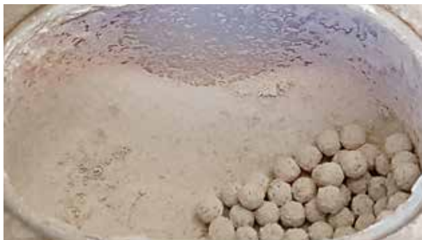
Abbildung eines Thiophosphat-Pulvers mit 3 mm großen Mahlkugeln in einem 125 ml Screw-Lock-Mahlbecher. Die Probe wurde in der MM 500 control bei -100 °C unter inerter Atmosphäre pulverisiert; der Becher wurde in einer Glove Box geöffnet.
