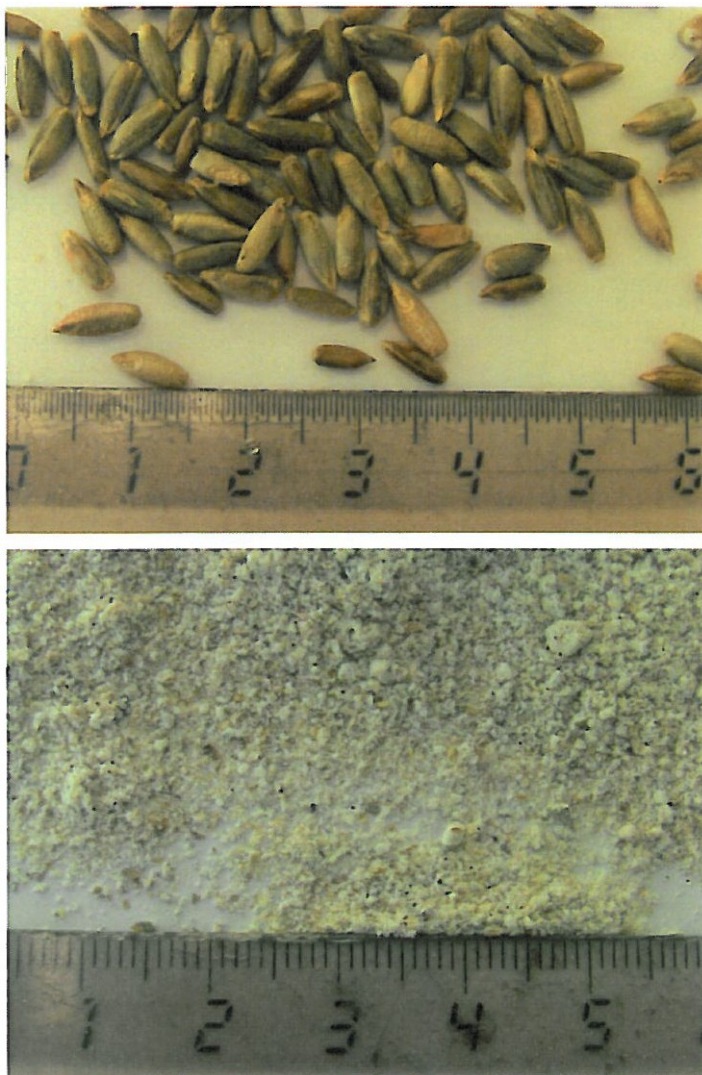
Abb. 3: Zerkleinerung von Roggen in der Zyklonmühle „Twister“
