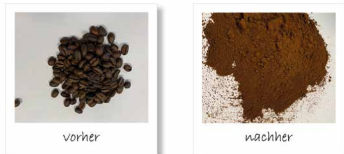
Abb. 3: Links: Röstkaffee vor und nach der Vermahlung in der MM 500 control (pro 125 ml Mahlbecher rostfreier Stahl: 5,4 g Kaffee, 8x20 mm Mahlkugel rostfreier Stahl), Solltemperatur -100°C, 25 min Vorkühlzeit, Vermahlung in 10 Zyklen (1 min 30 Hz + 0,5 min 5 Hz)
