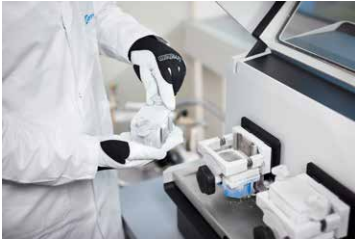
Abb. 2: Tiefkalte Mahlbecher im Kryogenbetrieb der MM 500 control
