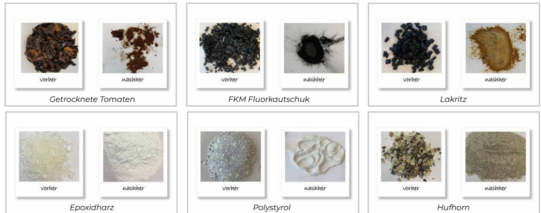
Abbildung 6: Verschiedene Materialien vor und nach der Vermahlung in der MM 500 control
