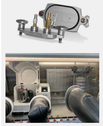
Abbildung 11: In der Schwingmühle MM 500 nano werden Mischprozesse trocken und nass durchgeführt.
