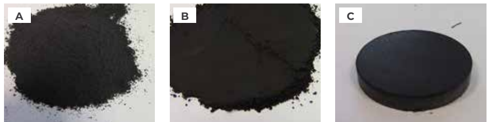
Abbildung 12: Probe von Manganoxid vor (a) und nach dem Mahlvorgang in der PM 100 (b). Für die RFA wird die Probe zu einem Pellet gepresst (c).
