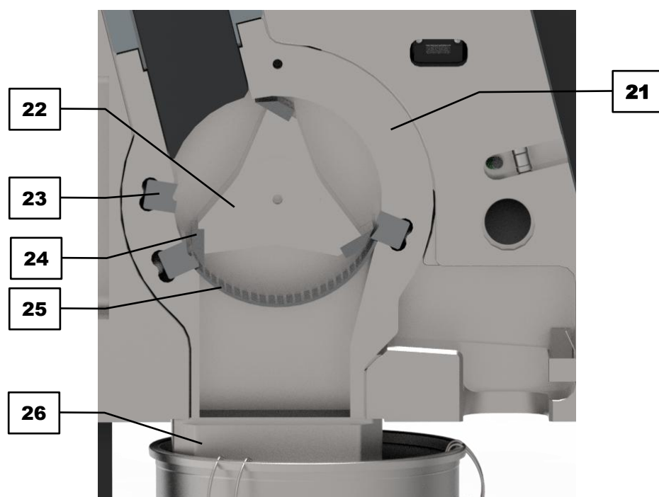
Рис. 5. Детальный вид гравитационной вставки с гравитационным выпуском
